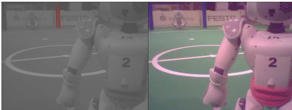
(c) nur der rechte Pfosten wurde korrekt erkannt, da der linke Pfosten nicht vollständig im Bild ist
