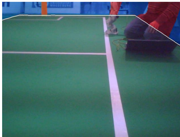
Abbildung 4.3: Die relevanten Pixel sind blau eingefärbt und die erkannte Feldgrenze EFG durch eine weiße Linie gekennzeichnet
