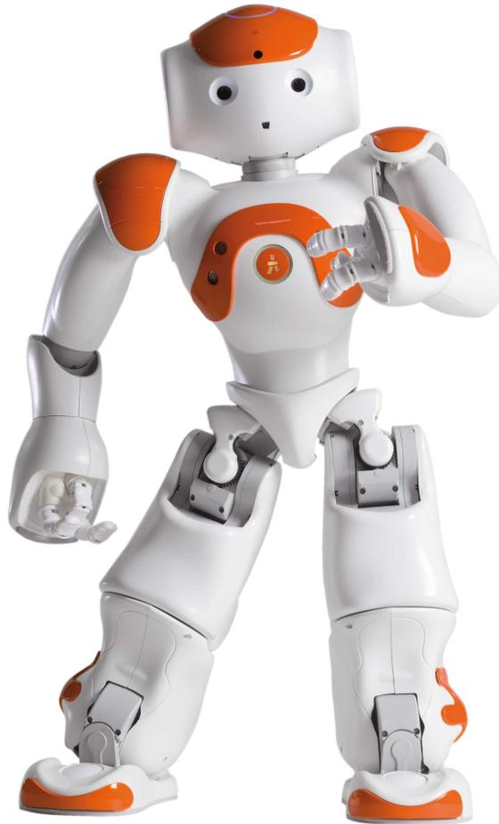
**Abbildung 2.3.** – Nao Standardplattform, hier in orange. Bei Verwendung während des RoboCups sind standardmäßig alle farbige Bauteile einheitlich grau (Quelle: Aldebaran Pressematerial, [www.aldebaran-robotics.com/](http://www.aldebaran-robotics.com/)).
