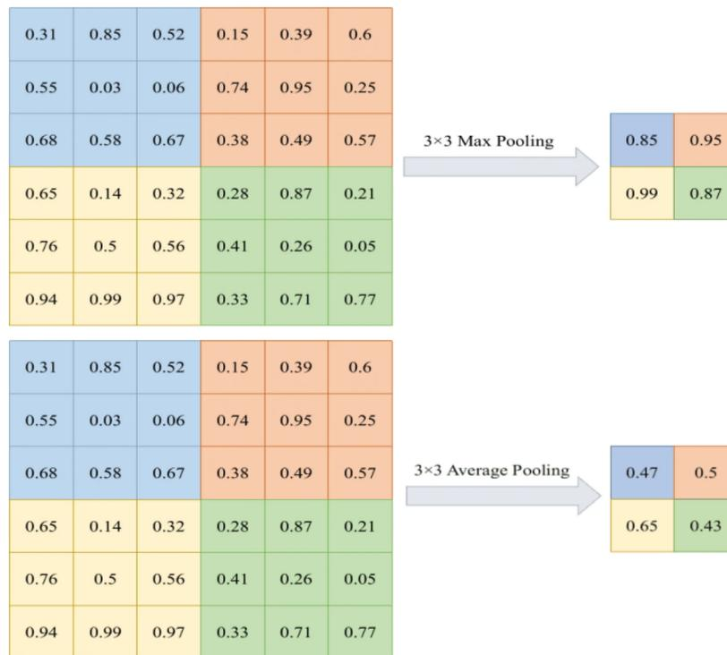
Abbildung 3.4: Max Pooling und Average Pooling mit Kernelgröße 3 und Stride 3 (siehe Abschnitt 3.2.3) [16]
